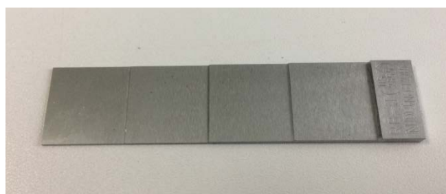
Fig.1 超音波厚さ計用対比試験片
