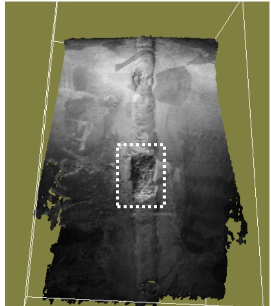
第5図 腐食の3D画像 (その2) (モノクロテクスチャ付き)
