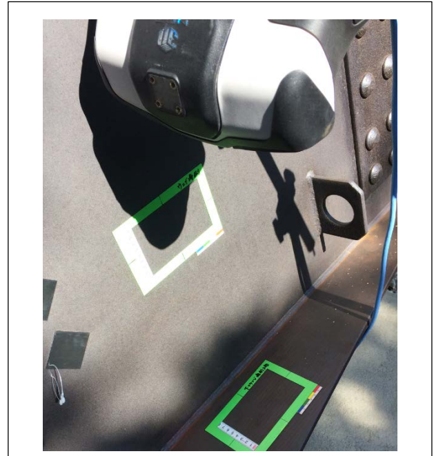
図7 光3次元計測装置を用いた実際の耐候性鋼の計測の様子
