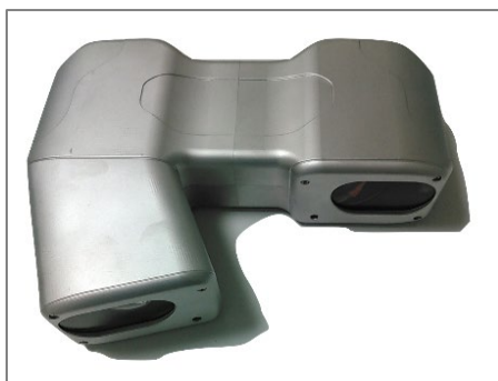
『Puma』(滑走路路面亀裂検査用)
