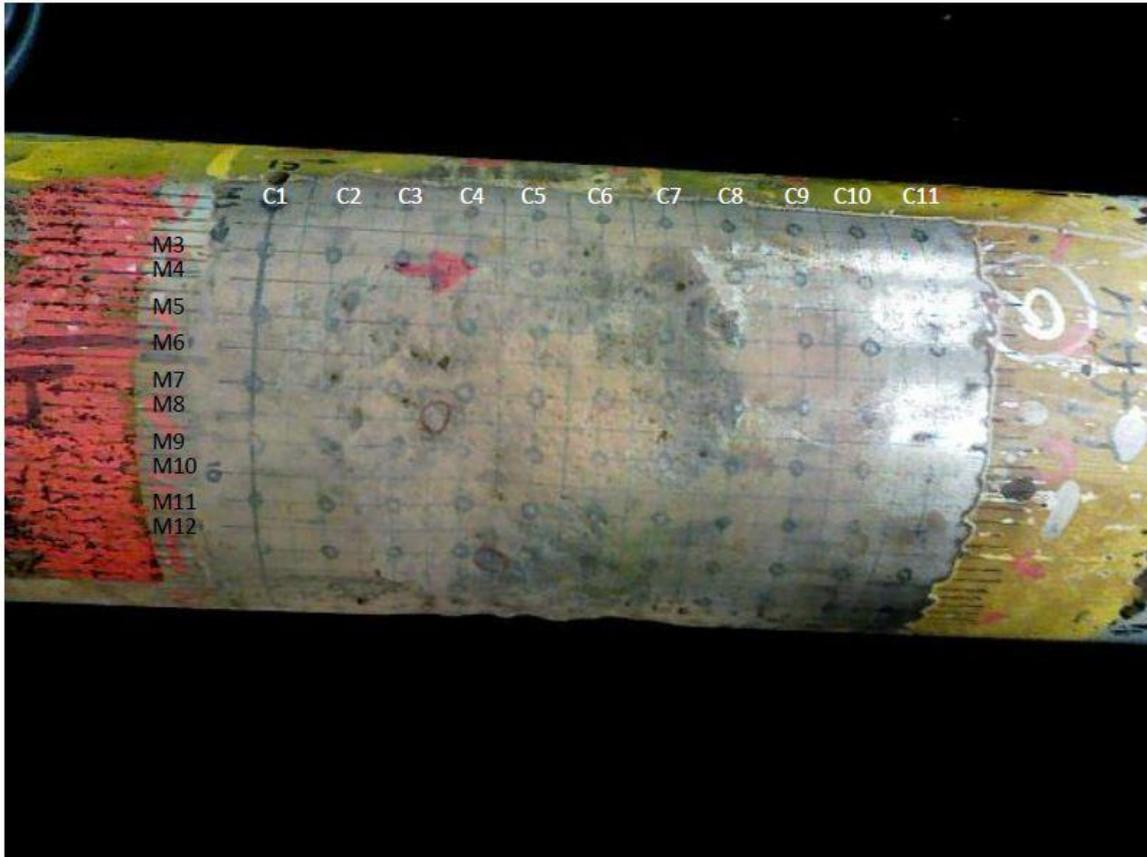
図8. 腐食鉄管（計測精度検証用）
