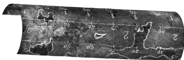
図1. 配管外観(3次元データ)
