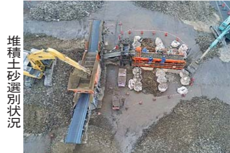
リサイクル率95・2% 鴻池組、佐野市の災害廃棄物中間処理完了
